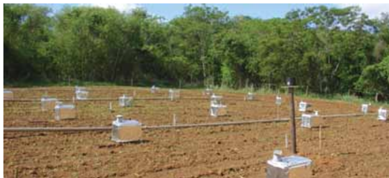
Figura 1: Dispositivo experimental para determinação do fluxo de N 2 O
